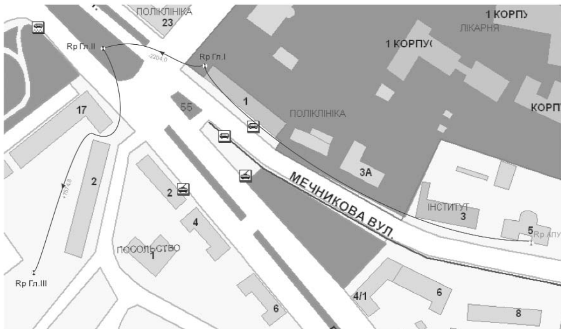
Рисунок 1. Схема нівелювання геодезичної висотної основи
